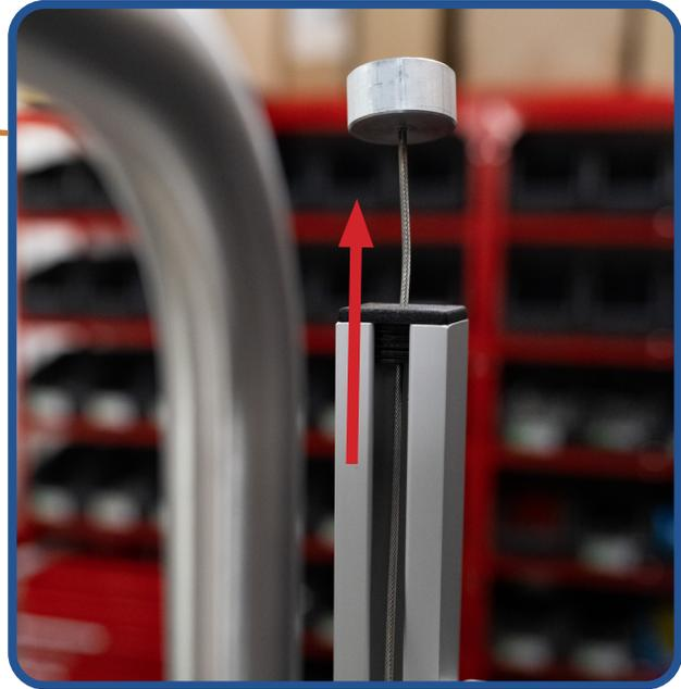
**10. Jetzt die neuen Züge in umgekehrter Reihenfolge wieder einziehen und einbauen.**
