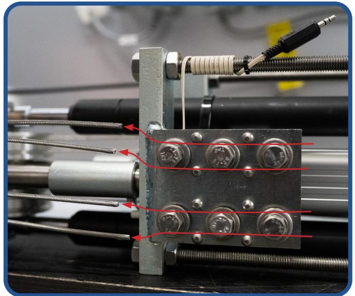
**9. Alle Bowdenzughüllen aus der Aufnahme am Motor ziehen und von der Umlenkrolle entfernen.**
